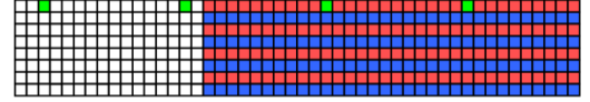
Gambar 6. Komposisi dari circular buffer pada LTE turbo code rate matching . Sel berwarna putih, merah, dan biru berurutan digunakan untuk aliran Systematic , Parity 0 , dan Parity 1 dibaca per baris. Untuk sel warna hijau ditandai untuk starting points dari RVs pada RM. Indeks RVs terdiri dari 0,1,2 atau 3. Hal ini dilakukan apabila ditransmisikan gagal, maka akan dilakukan pengiriman ulang per RVs [3] .
