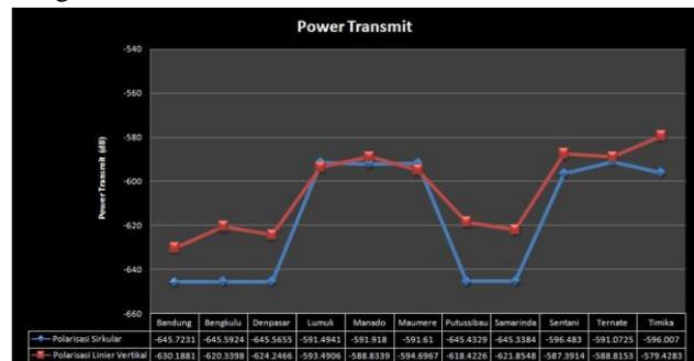
Gambar 4.12 Gambar power transmit untuk polarisasi linier vertikal dan sirkular
